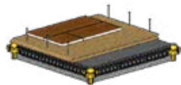
→ OSB/Durelis Holzplatte als Zwischenschicht
